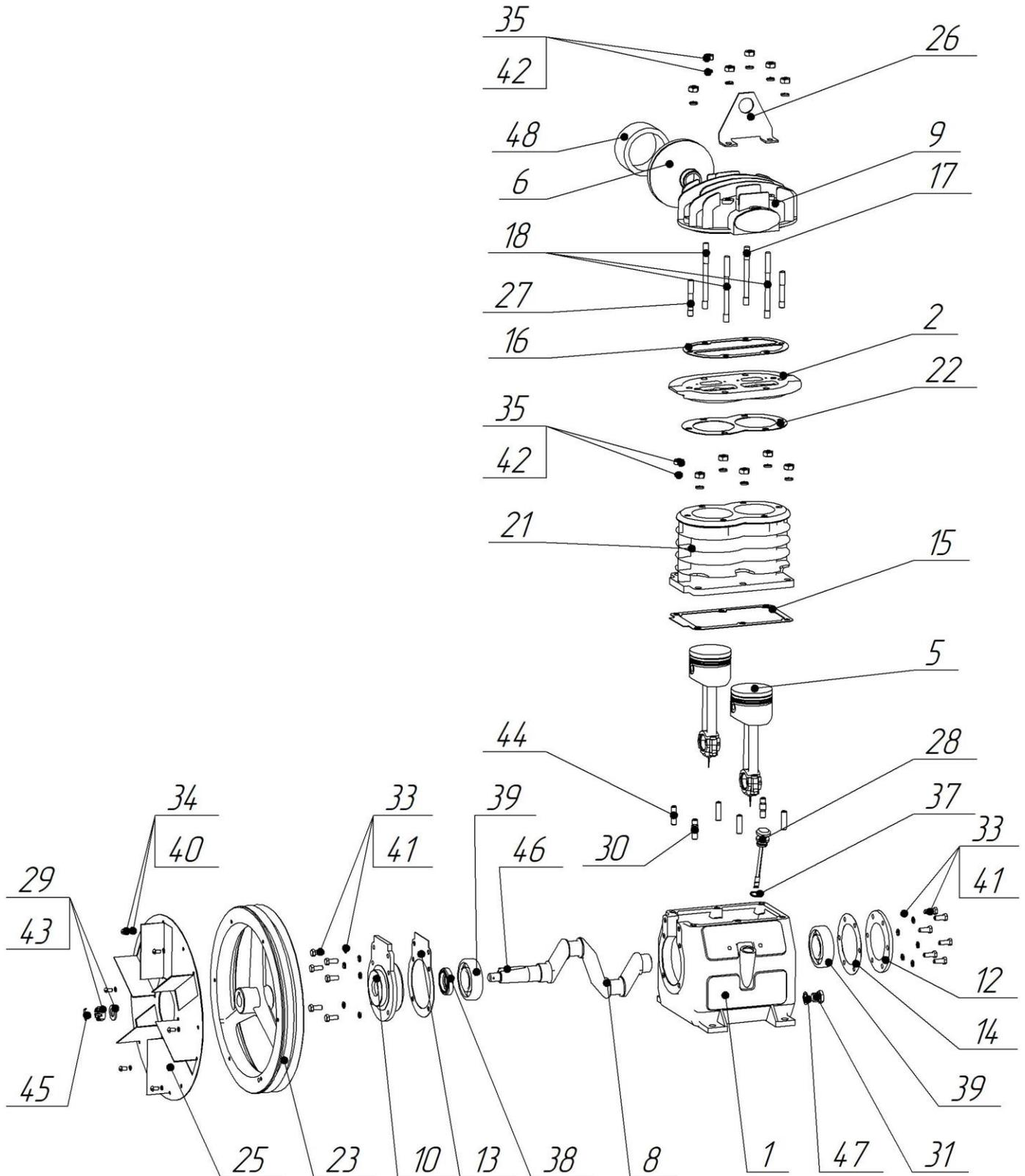
Устройство компрессорной головки
