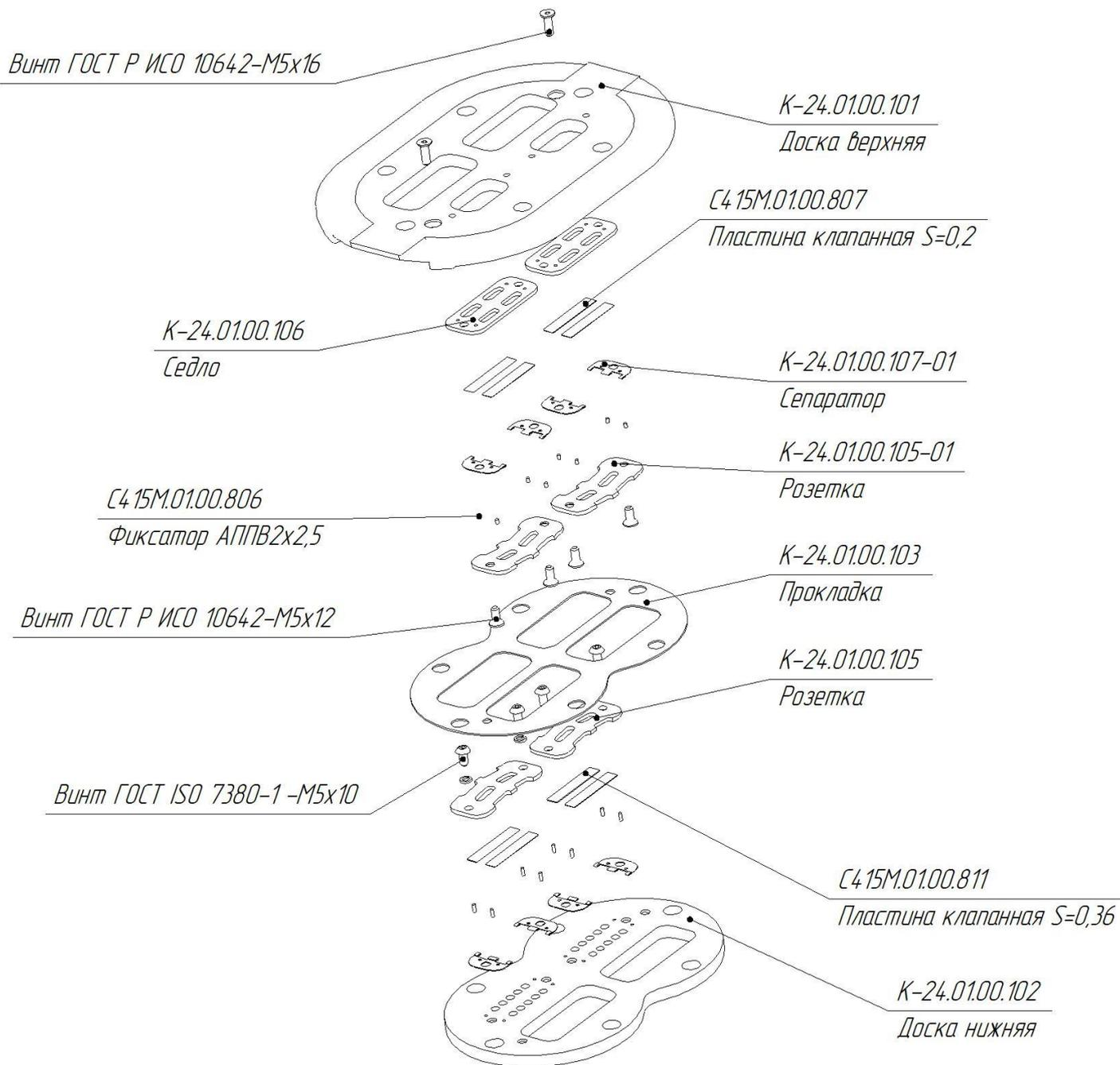
**Устройство компрессорной головки К24М**
