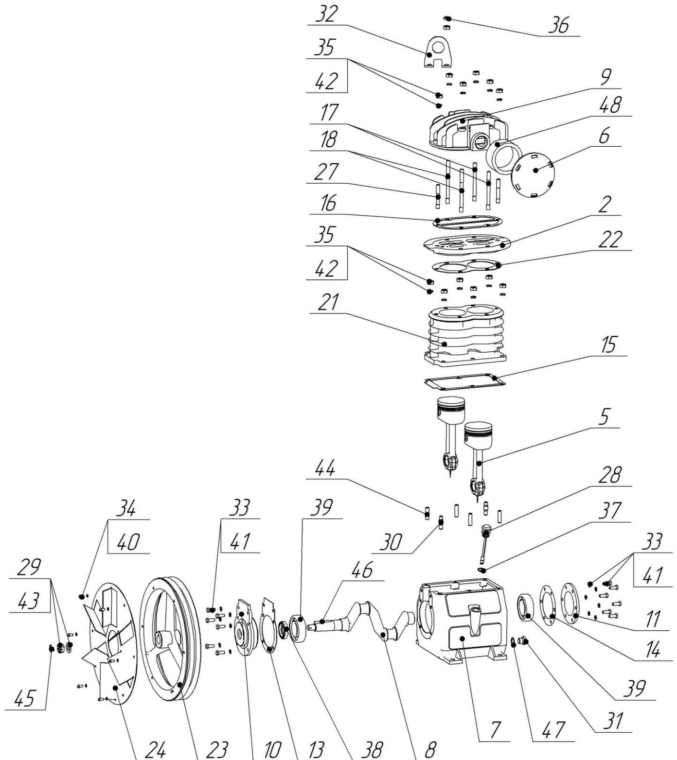
**Устройство компрессорной головки
