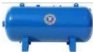
Компрессор размещен на **горизонтальном воздушном ресивере объемом 100 л**. Бежецкий завод "АСО" более 80 лет производит воздухосборники разного объема (от 10 до 900 литров) для сжатого воздуха давлением до 25 атм. Ресиверы окрашиваются на автоматической итальянской линии порошковой окраски.
