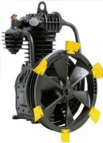
Массивная и надежная **поршневая компрессорная головка С415М** производится Бежецким заводом "АСО", является основным узлом компрессора и предназначена для сжатия воздушной смеси. Сжатие воздуха происходит в двухступенчатом режиме при прохождении по цилиндрю высокого и низкого давления. При достижении заданного давления сжатый воздух поступает в ресивер.
