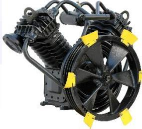
Массивная и надежная **поршневая компрессорная головка C416M** производится Бежецким заводом "АСО", является основным узлом компрессора и предназначена для сжатия воздушной смеси. Сжатие воздуха происходит в двухступенчатом режиме при прохождении по цилиндрам высокого и низкого давления. При достижении заданного давления сжатый воздух поступает в ресивер.
