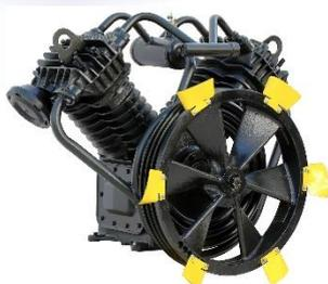
Массивная и надежная **поршневая компрессорная головка С416М** производится Бежецким заводом "АСО", является основным узлом компрессора и предназначена для сжатия воздушной смеси. Сжатие воздуха происходит в двухступенчатом режиме при прохождении по цилиндрам высокого и низкого давления. При достижении заданного давления сжатый воздух поступает в ресивер.
