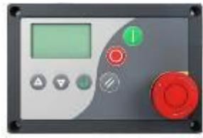
Программируемый многофункциональный контроллер **СМС Airmaster P1 и S1** производится в Бельгии. Контроллер Airmaster отображает текущую информацию о состоянии компрессора, о его нагрузке/ходостом ходу, времени отключения, аварийных режимах, времени наработки, обеспечивает доступ к настройкам компрессора, а также о предстоящих ТО. Контроллер Airmaster защищает компрессор и производит его остановку при аварийных ситуациях. Есть возможность дистанционно управлять компрессором.
