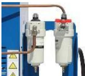
Сжатый воздух обычно содержит вредные примеси в твердом, жидком или парообразном состоянии, которые могут привести к преждевременному износу подключенное оборудование или его компоненты. Для тонкой очистки сжатого воздуха мы применяем **фильтры на основе ультратонкого стекловолокна.**
