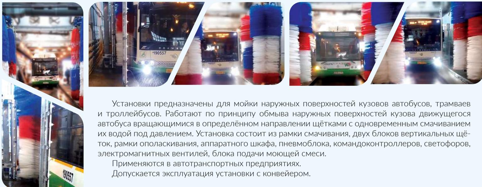
Установки предназначены для мойки наружных поверхностей кузовов автобусов, трамваев и троллейбусов. Работают по принципу обмыва наружных поверхностей кузова движущегося автобуса вращающимися в определённом направлении щётками с одновременным смачиванием их водой под давлением. Установка состоит из рамки смачивания, двух блоков вертикальных щёток, рамки ополаскивания, аппаратного шкафа, пневмоблока, командоконтроллеров, светофоров, электромагнитных вентилях, блока подачи моющей смеси.
