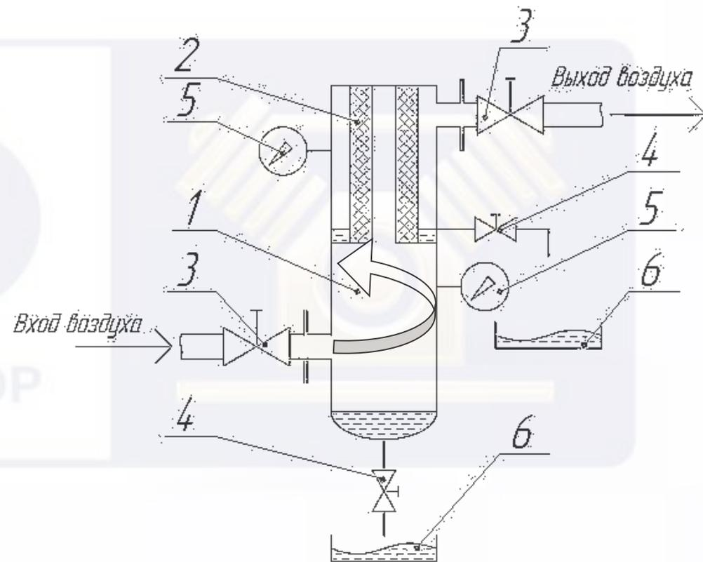
Рисунок 3. Схема подсоединения магистрального фильтра в пневмосеть.
