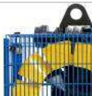
**Сетчатое ограждение** надежно изолирует ременную передачу поршневого компрессора во время его работы от обслуживающего персонала. Для удобного и безопасного открывания или снятия ограждения предусмотрены специальные замки. Ограждение составляет единое целое с конструкцией компрессора и соответствует требованиям технической эстетики.
