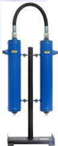
Фильтрационный модуль предназначен для тонкой очистки сжатого воздуха и различных газов от аэрозолей масла и влаги, а также от твердых частиц размером более 3 мкм. Обеспечиваемое остаточное содержание аэрозоля масла - менее 5 мг/м<sup>3</sup>. Используется в системах пневмоуправления и автоматики, пневмоприводе устройств и инструмента для окраски поверхностей распылением.
