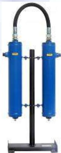
Фильтрационный модуль предназначен для тонкой очистки сжатого воздуха и различных газов от аэрозолей масла и влаги, а также от твердых частиц размером менее 1 мкм. Обеспечиваемое остаточное содержание аэрозоля масла - менее 0,1 мг/м<sup>3</sup>. Используется в системах пневмоуправления и автоматики, пневмоприводе устройств и инструмента для окраски поверхностей распылением.
