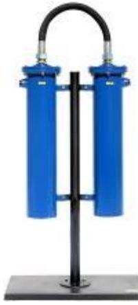
Фильтрационный модуль предназначен для тонкой очистки сжатого воздуха и различных газов, от аэрозолей масла и влаги, а также от твердых частиц размером более 10 мкм. Обеспечиваемое остаточное содержание аэрозоля масла - менее 16 мг/м<sup>3</sup>. Используется в системах пневмоуправления и автоматики, пневмоприводе устройств и инструмента для окраски поверхностей распылением.
