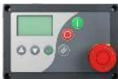
Программируемый многофункциональный контроллер **СМС Airmaster P1 и S1** производится в Бельгии. Контроллер Airmaster отображает текущую информацию о состоянии компрессора, о его нагрузке/холостом ходу, времени отключения, аварийных режимах, времени наработки, обеспечивает доступ к настройкам компрессора, а также о предстоящих ТО. Контроллер Airmaster защищает компрессор и производит его остановку при аварийных ситуациях. Есть возможность дистанционно управлять компрессором.
