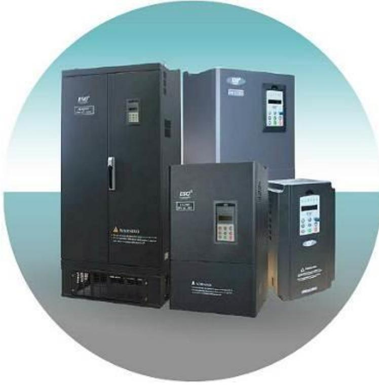
Преобразователь частоты представляет собой электронный блок управления, регулирующий скорость вращения электромотора путем модуляции, подаваемого на него тока. Частотный преобразователь в винтовом компрессоре обеспечивает постоянный контроль, изменяя скорость двигателя, чтобы четко следовать за потребностью в сжатом воздухе. Осуществляет полную защиту электродвигателя и позволяет проводить мониторинг всей системы в целом.
