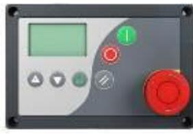
Программируемый многофункциональный контроллер **CMC Airmaster P1 и S1** производится в Бельгии. Контроллер Airmaster отображает текущую информацию о состоянии компрессора, о его нагрузке/холостом ходу, времени отключения, аварийных режимах, времени наработки, обеспечивает доступ к настройкам компрессора, а также о предстоящих ТО. Контроллер Airmaster защищает компрессор и производит его остановку при аварийных ситуациях. Есть возможность дистанционно управлять компрессором.
