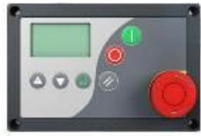
Программируемый многофункциональный контроллер **СМС Airmaster P1 и S1** производится в Бельгии. Контроллер Airmaster отображает текущую информацию о состоянии компрессора, о его нагрузке/ходистом ходу, времени отключения, аварийных режимах, времени наработки, обеспечивает доступ к настройкам компрессора, а также о предстоящих ТО. Контроллер Airmaster защищает компрессор и производит его остановку при аварийных ситуациях. Есть возможность дистанционно управлять компрессором.
