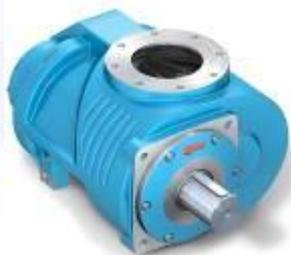
**Винтовой блок EVO28** производится компанией Rotorcomp (Германия) и является основой винтового компрессора. Визуально он представляет собой чугунный корпус, внутри которого, на подшипниках размещены два ротора, сжимающие воздух.
