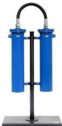
Фильтрационный модуль предназначен для тонкой очистки сжатого воздуха и различных газов, от аэрозолей масла и влаги, а также от твердых частиц размером более 10 мкм. Обеспечиваемое остаточное содержание аэрозоля масла - менее 16 мг/м<sup>3</sup>. Используется в системах пневмоуправления и автоматики, пневмоприводе устройств и инструмента для окраски поверхностей распылением.
