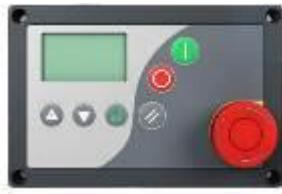
Программируемый многофункциональный контроллер **СМС Airmaster P1 и S1** производится в Бельгии. Контроллер Airmaster отображает текущую информацию о состоянии компрессора, о его нагрузке/холостом ходу, времени отключения, аварийных режимах, времени наработки, обеспечивает доступ к настройкам компрессора, а также о предстоящих ТО. Контроллер Airmaster защищает компрессор и производит его остановку при аварийных ситуациях. Есть возможность дистанционно управлять компрессором.
