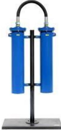
Фильтрационный модуль предназначен для тонкой очистки сжатого воздуха и различных газов, от аэрозолей масла и влаги, а также от твердых частиц размером более 10 мкм. Обеспечиваемое остаточное содержание аэрозоля масла - менее 16 мг/м<sup>3</sup>. Используется в системах пневмоуправления и автоматики, пневмоприводе устройств и инструмента для окраски поверхностей распылением.
