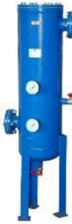
Фильтрационный модуль предназначен для тонкой очистки сжатого воздуха и различных газов, от аэрозолей масла и влаги, а также от твердых частиц размером более 10 мкм. Обеспечиваемое остаточное содержание аэрозоля масла - менее 16 мг/м³. Используется в системах пневмоуправления и автоматики, пневмоприводе устройств и инструмента для окраски поверхностей распылением.
