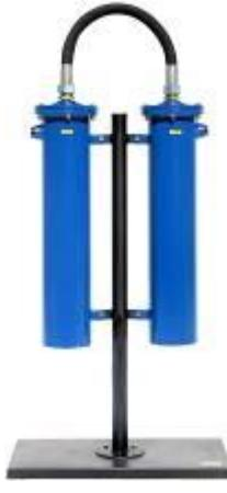
Фильтрационный модуль предназначен для тонкой очистки сжатого воздуха и различных газов, от аэрозолей масла и влаги, а также от твердых частиц размером более 10 мкм. Обеспечиваемое остаточное содержание аэрозоля масла - менее 16 мг/м³. Используется в системах пневмоуправления и автоматики, пневмоприводе устройств и инструмента для окраски поверхностей распылением.
