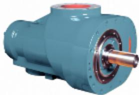
**Винтовой блок CF180G2** производится концерном **GHH-RAND** (Германия) и является основой винтового компрессора. Визуально он представляет собой чугунный корпус, внутри которого, на подшипниках размещены два ротора, сжимающие воздух.
