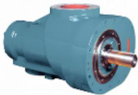
**Винтовой блок CF180R** производится концерном **GHH-RAND** (Германия) и является основой винтового компрессора. Визуально он представляет собой чугунный корпус, внутри которого, на подшипниках размещены два ротора, сжимающие воздух.
