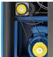
**Ременный привод** "сглаживает" пуск компрессора за счет растяжения ремней, надежен при низких и средних мощностях двигателя. Он прост в эксплуатации, благодаря чему, обслуживание может осуществляться самостоятельно, без необходимости привлечения специалистов. Ременной привод получил на винтовых компрессорах наибольшее применение. А стоимость компрессоров с ременным приводом ниже аналогичных моделей с другим типом привода.
