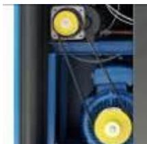
**Ременный привод** "сглаживает" пуск компрессора за счет растяжения ремней, надежен при низких и средних мощностях двигателя. Он прост в эксплуатации, благодаря чему, обслуживание может осуществляться самостоятельно, без необходимости привлечения специалистов. Ременной привод получил на винтовых компрессорах наибольшее применение. А стоимость компрессоров с ременным приводом ниже аналогичных моделей с другим типом привода.
