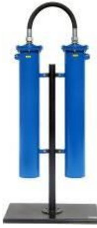
Фильтрационный модуль предназначен для тонкой очистки сжатого воздуха и различных газов, от аэрозолей масла и влаги, а также от твердых частиц размером более 10 мкм. Обеспечиваемое остаточное содержание аэрозоля масла - менее 16 мг/м<sup>3</sup>. Используется в системах пневмоуправления и автоматики, пневмоприводе устройств и инструмента для окраски поверхностей распылением.
