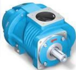
**Винтовой блок EVO6** производится компанией Rotorcomp (Германия) и является основой винтового компрессора. Визуально он представляет собой чугунный корпус, внутри которого, на подшипниках размещены два ротора, сжимающие воздух.
