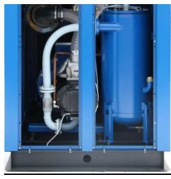
**Винтовой блок EVO9** производится немецкой фабрикой Rotorcomp (Германия) и является основой винтового компрессора. Визуально он представляет собой чугунный корпус, внутри которого, на подшипниках размещены два ротора, сжимающие воздух.
