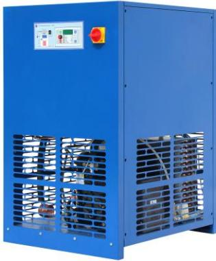
Предельное содержание влаги с понижением температуры воздуха значительно сокращается. Например, кубический метр воздуха при температуре +40°C содержит до 55г влаги, а при +3°C - менее 6г. Осушители серии ОВ удаляют влагу из воздуха посредством понижения его температура до точки росы +3°C (4 класс ISO 8573-1).
