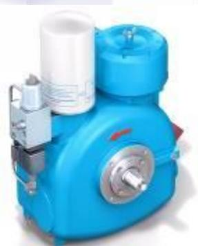
**Винтовой блок НК-31** производится компанией Rotorcomp (Германия) и является основой винтового компрессора. Визуально он представляет собой чугунный корпус, внутри которого, на подшипниках размещены два ротора, сжимающие воздух.
