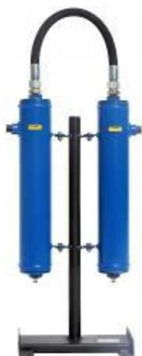
Фильтрационный модуль предназначен для очистки сжатого воздуха и различных газов от аэрозолей, масла и влаги, а также от твердых частиц размером более 10 мкм. Обеспечиваемое остаточное содержание аэрозоля масла - менее 16 мг/м<sup>3</sup>. Используется в системах пневмоуправления и автоматики, пневмоприводе устройств и инструмента для окраски поверхностей распылением.
