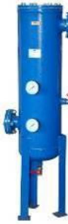
Фильтрационный модуль предназначен для тонкой очистки сжатого воздуха и различных газов, от аэрозолей масла и влаги, а также от твердых частиц размером более 10 мкм. Обеспечиваемое остаточное содержание аэрозоля масла - менее 16 мг/м<sup>3</sup>. Используется в системах пневмоуправления и автоматики, пневмоприводе устройств и инструмента для окраски поверхностей распылением.
