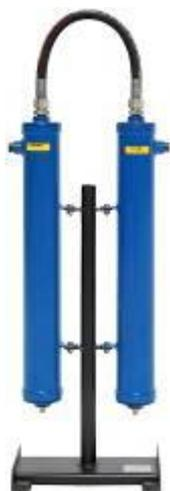
Фильтрационный модуль предназначен для тонкой очистки сжатого воздуха и различных газов, от аэрозолей масла и влаги, а также от твердых частиц размером более 10 мкм. Обеспечиваемое остаточное содержание аэрозоля масла - менее 16 мг/м<sup>3</sup>. Используется в системах пневмоуправления и автоматики, пневмоприводе устройств и инструмента для окраски поверхностей распылением.
