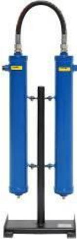
Фильтрационный модуль предназначен для тонкой очистки сжатого воздуха и различных газов от аэрозолей, масла и влаги, а также от твердых частиц размером более 10 мкм. Обеспечиваемое остаточное содержание аэрозоля масла - менее 16 мг/м<sup>3</sup>. Используется в системах пневмоуправления и автоматики, пневмоприводе устройств и инструмента для окраски поверхностей распылением.
