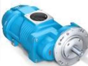
**Винтовой блок EVO15G** производится компанией Rotorcomp (Германия) и является основой винтового компрессора. Визуально он представляет собой чугунный корпус, внутри которого, на подшипниках размещены два ротора, сжимающие воздух.
