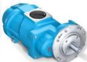
**Винтовой блок EVO15G** производится компанией Rotorcomp (Германия) и является основой винтового компрессора. Визуально он представляет собой чугунный корпус, внутри которого, на подшипниках размещены два ротора, сжимающие воздух.
